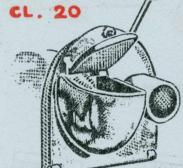
Tout en alliage inoxydable, trémie d'alimentation avec porte poussoir articulée, et trémie spéciale pour la coupe en rondelles des carottes, concombres,
